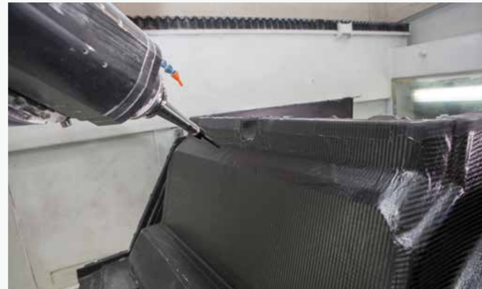
碳纤维结构件的加工。
