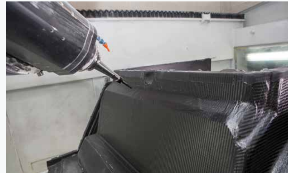
Usinage de composants structuraux en fibre de carbone.
