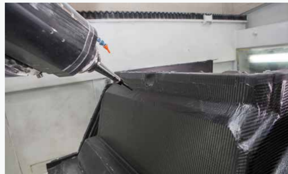
Lavorazione componente strutturale in fibra di carbonio.
