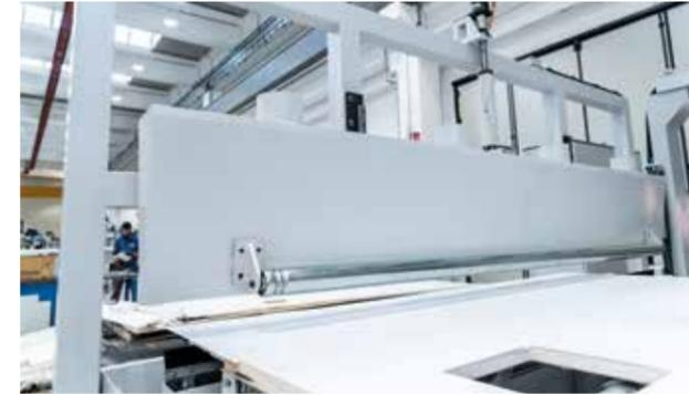
Barre de nettoyage de sortie commandée par CN
