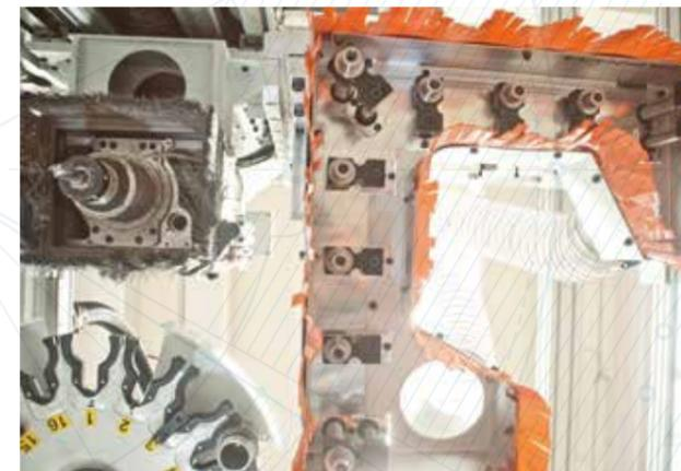
Machines à percer pneumatiques à l'arrière de l'entraxe réglable par CN
