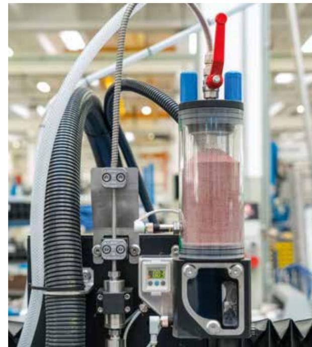
电子料斗，用于自动控制磨料流量。如果由于任何原因中断了磨料流，系统将自动停止以防止损坏切割头或损坏材料。此外，连接到混合室的真空传感器，不断地检测到向水刀供给的磨料的变化，从而提供有关切割头磨损状态的实时信息。
