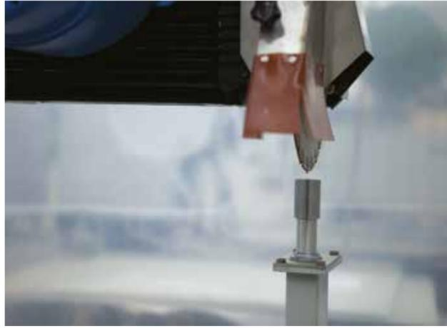
刀盘预先设置 可测量刀盘直径和指形钻头或岩心钻的长度。
