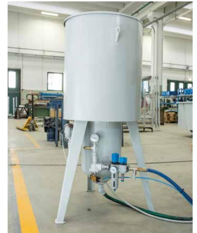
磨料驱动器的磨料输送能力为330 kg，配有两个磨料桶：一个容量为330 kg，另一个是增压磨料桶，用于切割头的进料（电子配料装置）。此外，还提供容量为2000kg的双级版本，可以完成长时间的工作，不会有由于缺少磨料所造成的中断以及由此对材料造成的损坏。
