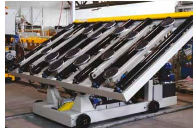
吸盘式自动上料器可在导轨上滑动,用于从垂直的板材托盘上捡取石板,然后将其倾翻至水平位置,以将其发送到加工线。此解决方案也可以应用于皮带式版本。
