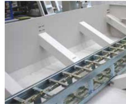
“无需维护”的链式疏通系统，用于自动清除残留磨料。收集槽内部的磨料疏通系统既受加工废料收集筐的保护，又受金属笼的保护。收集槽随时准备好，可以在稍后安装整个疏通组件。
