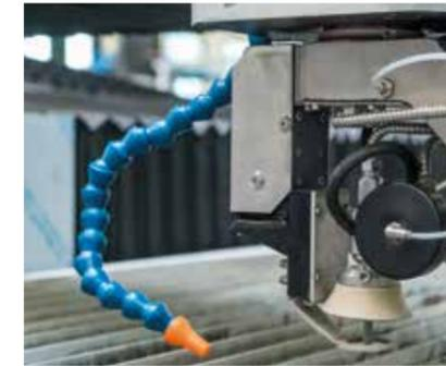
采用IKC (Intelligent Kerf Compensation, 智能切口补偿) 技术的5轴切割头 - 切割头的有效移动，可进行倾斜切割并控制切割槽的锥度。
