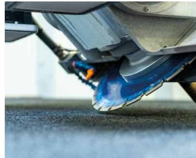
电动主轴由逆变器管理，可调节从0至5000的转速。它可以与金刚石工具一起用作手指钻头或岩心钻。工具的更换是手动进行的
