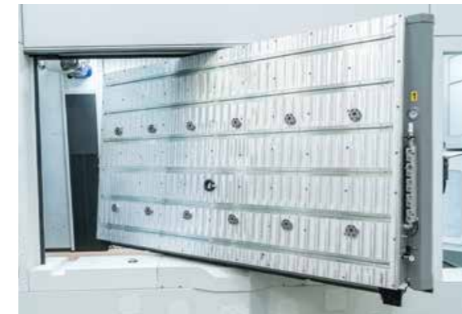
SUPERFICIE DE TRABAJO La superficie de trabajo se puede personalizar según las necesidades del cliente (Zero-Point, Vacuum, T-Slots, etc.)
