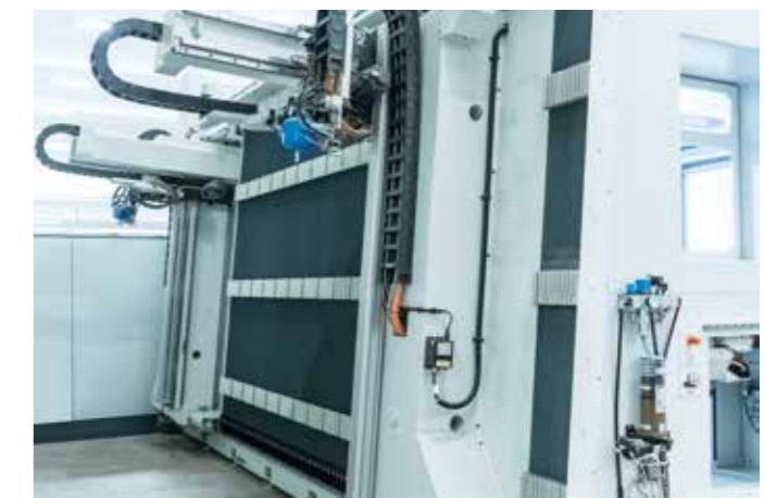
RECINTO TOTALMENTE CERRADO Recinto totalmente cerrado con cierre de fuelle trasero
