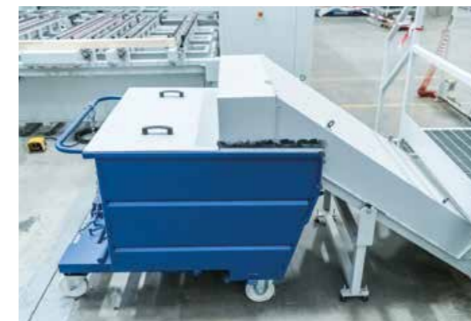
BANDA TRANSPORTADORA DE VIRUTAS Fácil eliminación de polvo, virutas y desechos de mecanizado
