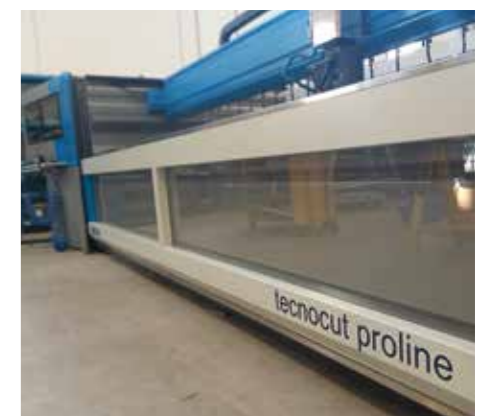
Porte avant et arrière avec mouvement pneumatique pour une meilleure protection de la zone de coupe et confinement de l'eau et des reflats abrasifs.
