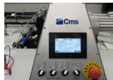
Contrôle électronique de la pression de coupe
