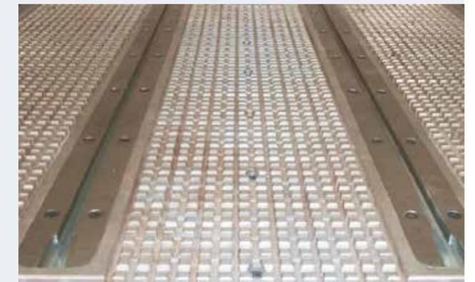
Aluminium-Sauganlage mit T-Nuten
