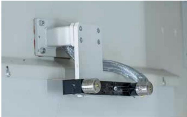
Lasergerät zur Messung von Werkzeugdurchmesser und -länge
