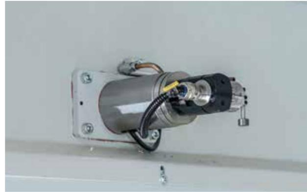
Vorrichtung zur Kontrolle und Neuausrichtung der Drehachsen
