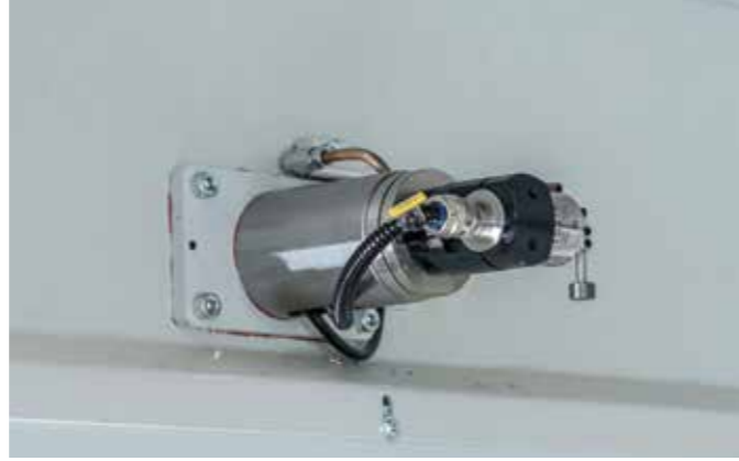
Dispositif de contrôle et de réalignement des axes rotatifs
