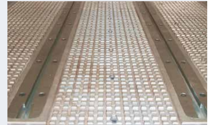
Aspirant en aluminium avec rainures en T
