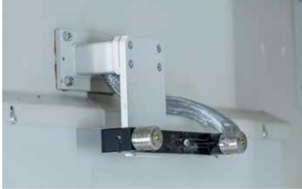
Dispositivo laser per la misurazione del diametro e della lunghezza dell'utensile
