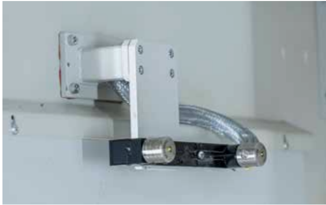
Dispositivo a laser para medição do diâmetro e comprimento da ferramenta
