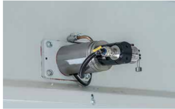
Dispositivo de controlo e realinhamento dos eixos rotativos
