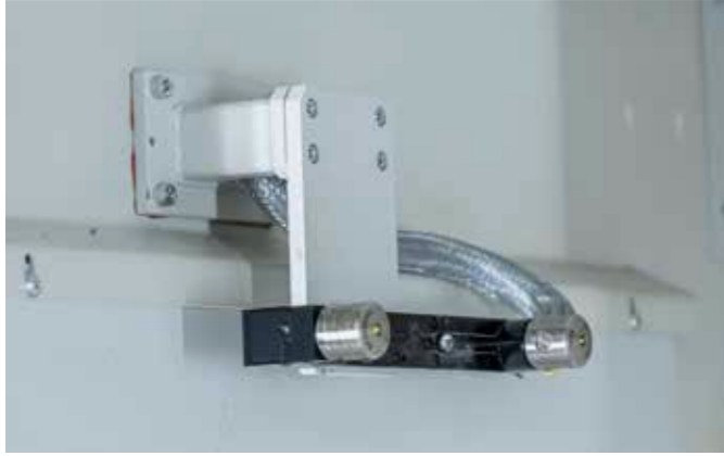
Dispositivo láser para medir el diámetro y la longitud de las herramientas
