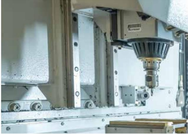
电离棒集成到底座和激光工具控制刀具是否存在和破损
