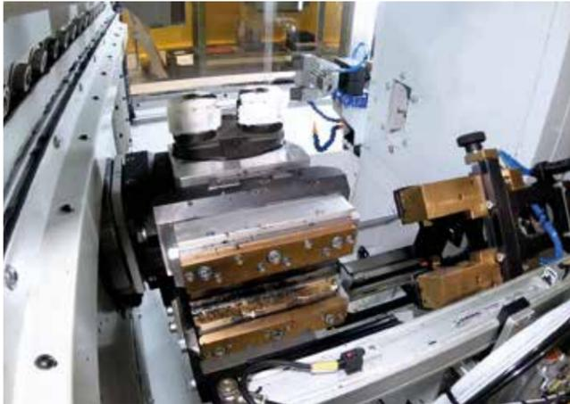
虎钳更换装置垂直移动，由数值控制轴控制，0-180° 旋转
