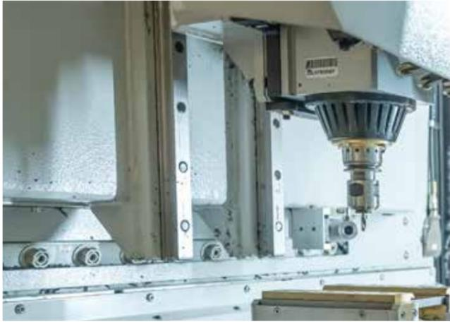
Barre ionisante intégrée dans le socle et laser contrôle présence et rupture outil
