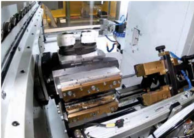
Dispositif de changement d'étau avec mouvement vertical commandé par axe CN et rotation 0-180°
