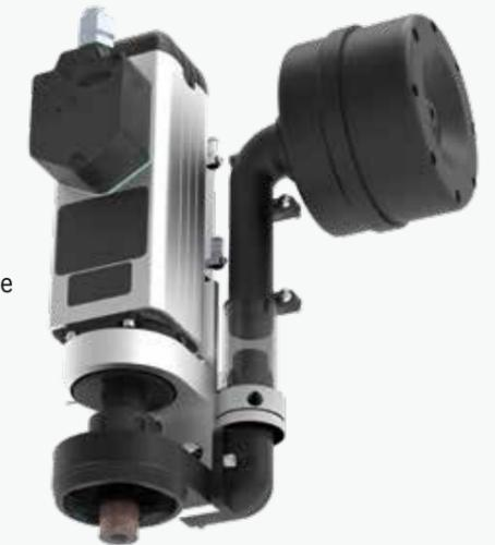
Mó dianteira para remoção automática de películas de baixa emissão (low-e). As tiras de película de 20 mm de largura podem ser removidas a uma velocidade de 40m/min.
