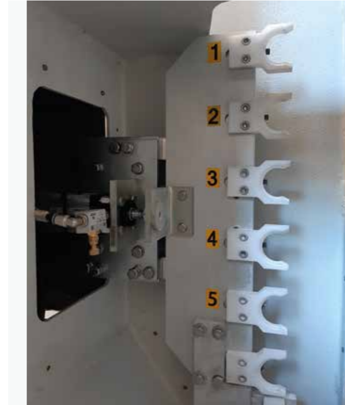
后刀库 机器最多可为钻孔器配备3个后刀库，每个刀库最大容量为6个ISO20锥体，总共18个锥体。
