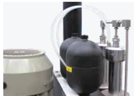
Accumulateur d'azote pour la gestion du circuit de retour des vérins hydrauliques
