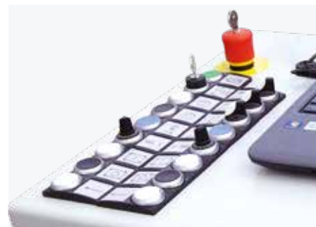
Contrôle de la pression et du fonctionnement de l'intensificateur de l'intensificateur géré directement à partir de la console
