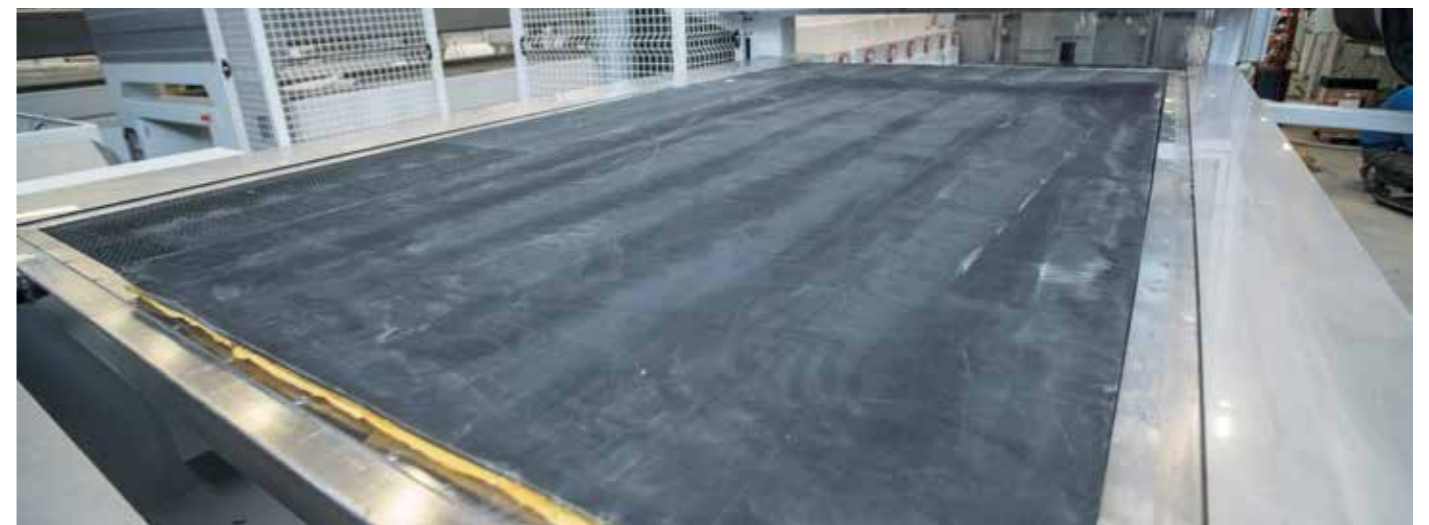
自动换托盘 装卸区分离，带有伺服电机驱动自动搬运托盘系统
