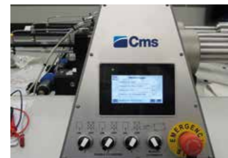
电子控制切割压力
