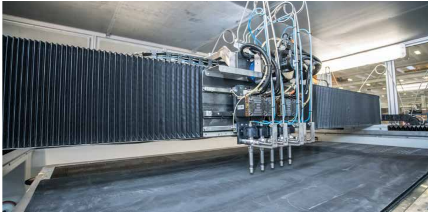
搬运 高精度、高性能齿轮齿条传动。
