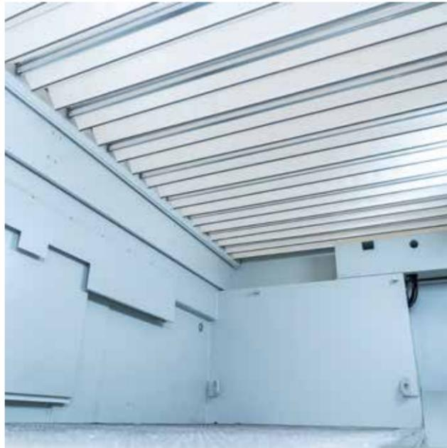
波纹管盖可限制烟雾、灰尘和切屑从工作区域逸出
