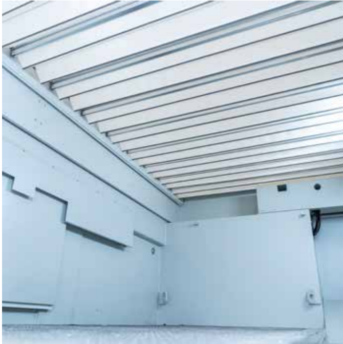
Couvercle à soufflet limitant la fuite de fumées, de poussières et de copeaux de la zone d'usinage
