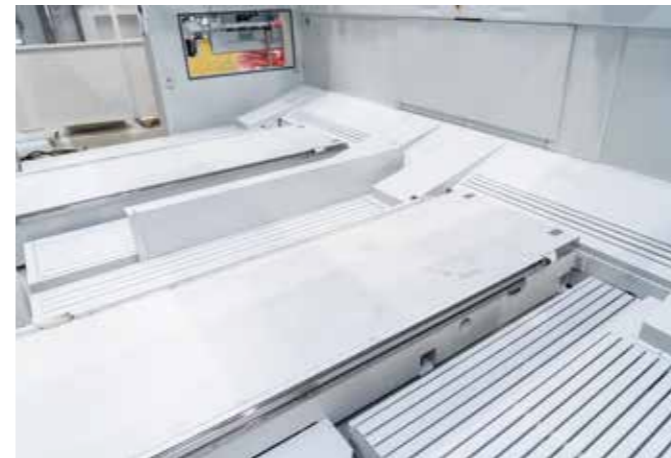
Cuves d'aspiration fixes sur les côtés des tables
