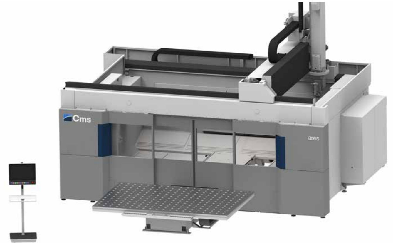
Ares avec table simple extractible 1APC (Automatic Pallet Change)
