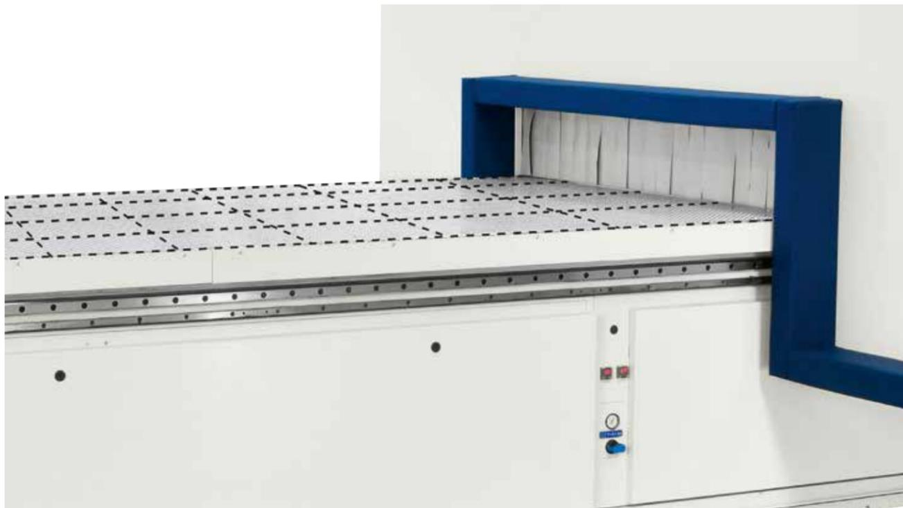
仅在必要时，最大限度地保夹工件：根据加工台的尺寸，可用从2到30个真空区。
