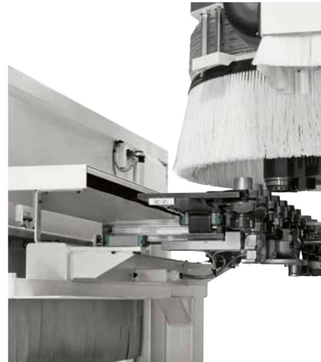
\* 对于所有可用的版本 拾取式刀库固定在移动横杆上。这种设计适合大型角度刀和刀具。
