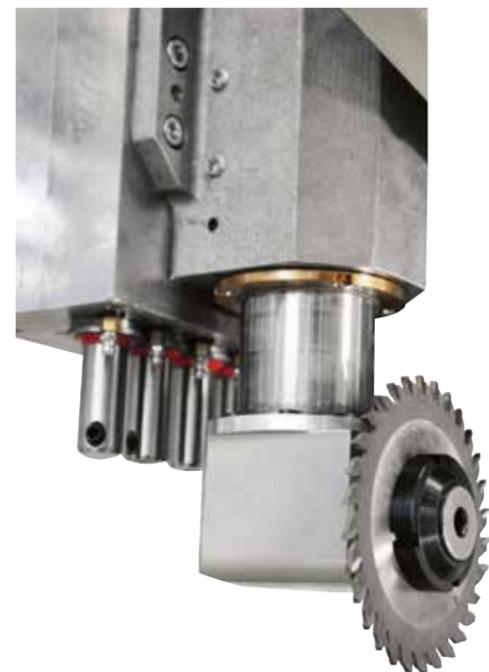
凭借0° - 90° 的刀片单元，可轻松沿X和Y方向进行切割和开槽操作。
