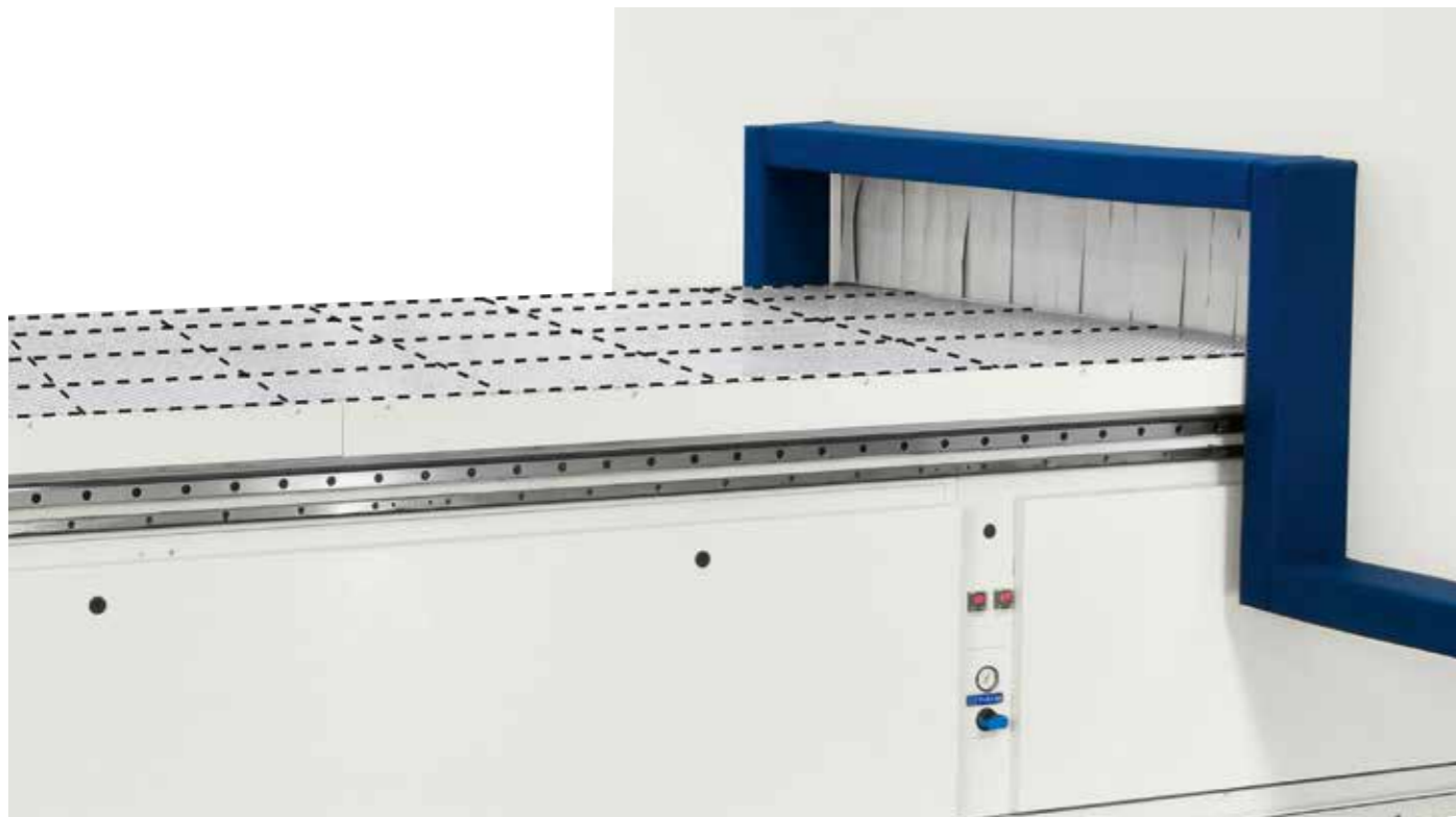
Tenue maximale des pièces uniquement là où cela est nécessaire : de 2 à 30 zones de vide en fonction des dimensions du plan de travail
