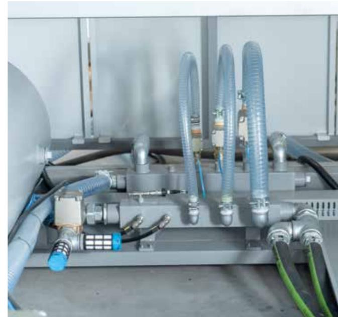
用于边缘成型的分离式双真空系统以及带内置罐和比例系统的槽体
