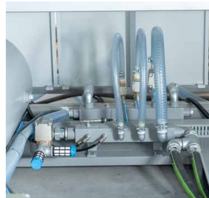
Doppio impianto vuoto separato per formatura bordo e corpo vasca con serbatoio integrato e sistema proporzionale
