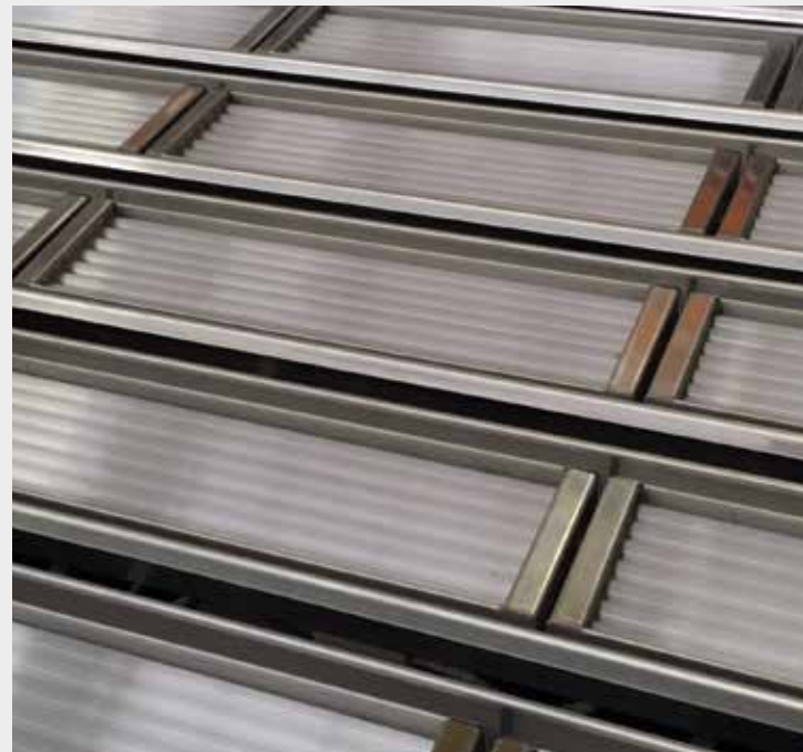
Sistema di riscaldamento con doppio pannello superiore ed inferiore con resistenza al quarzo
