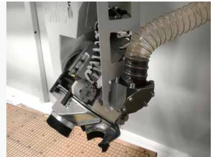
5 轴除尘机罩，对准切割区域进行吸气。用于更换和释放刀具的气动打开。
