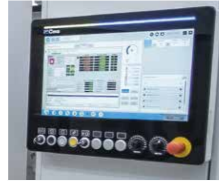
操作面板 完全自主研发的平板电脑控制台，IP53防护等级，无风扇散热系统。21.5英寸多点触摸屏。数控系统，可选择 OSAI CNC 或 GE FANUC。
