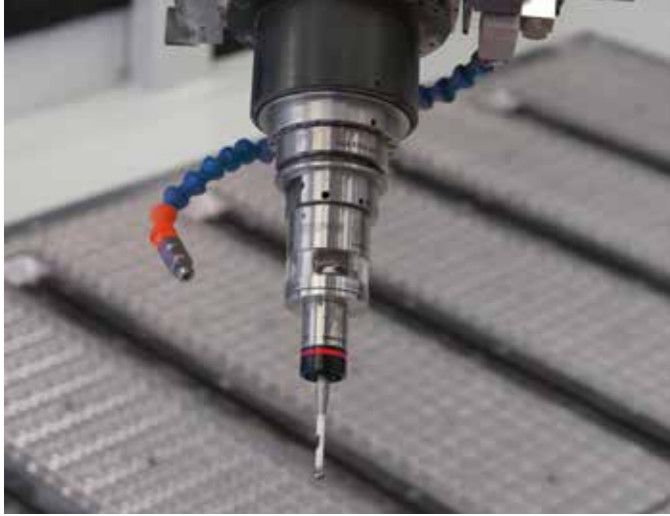
刀架上安装的探头设备，通过无线电传输信号。
