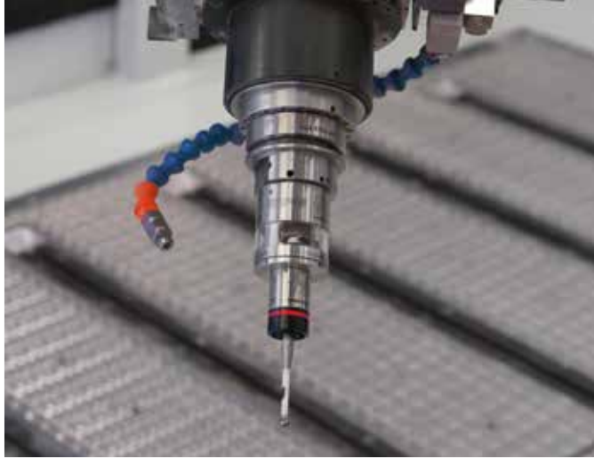
Palpeur monté sur porte-outils avec transmission par radio du signal.
