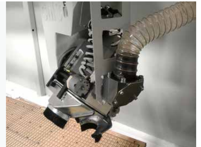
Coiffe d'aspiration à 5 axes pour une aspiration concentrée sur la zone de coupe. Ouverture pneumatique pour le changement et le déverrouillage de l'outil.
