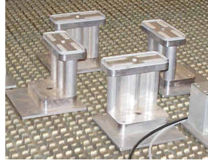
Ventouses et assemblages de références pour un maximum de souplesse de verrouillage des pièces.
