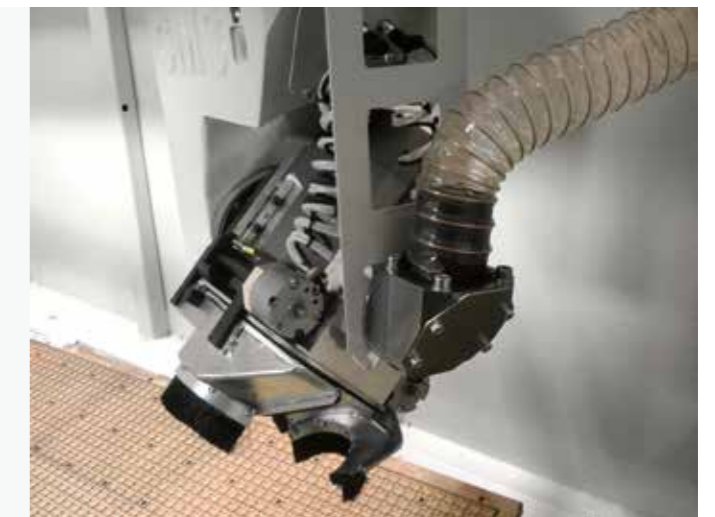
Cuffia di aspirazione a 5 assi per una aspirazione concentrata sulla zona di taglio. Apertura pneumatica per cambio utensile e svincolo.
