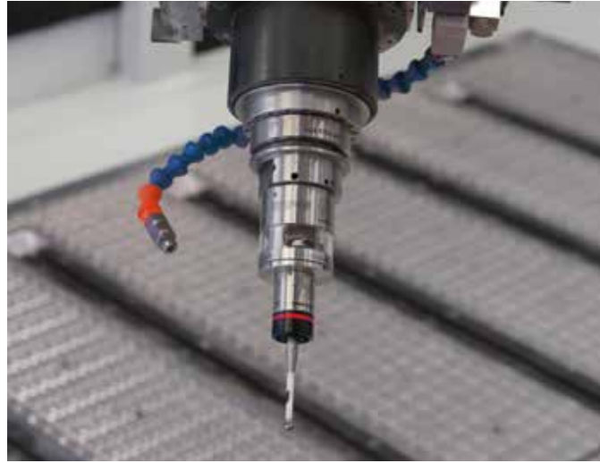
Dispositivo di tastatura montato su portautensile con trasmissione via radio del segnale.
