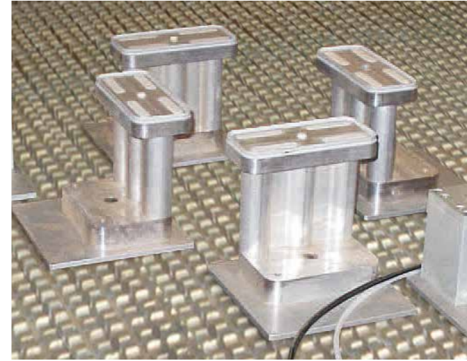
Ventose e fermi di riferimento per la massima flessibilità di bloccaggio pezzo.
