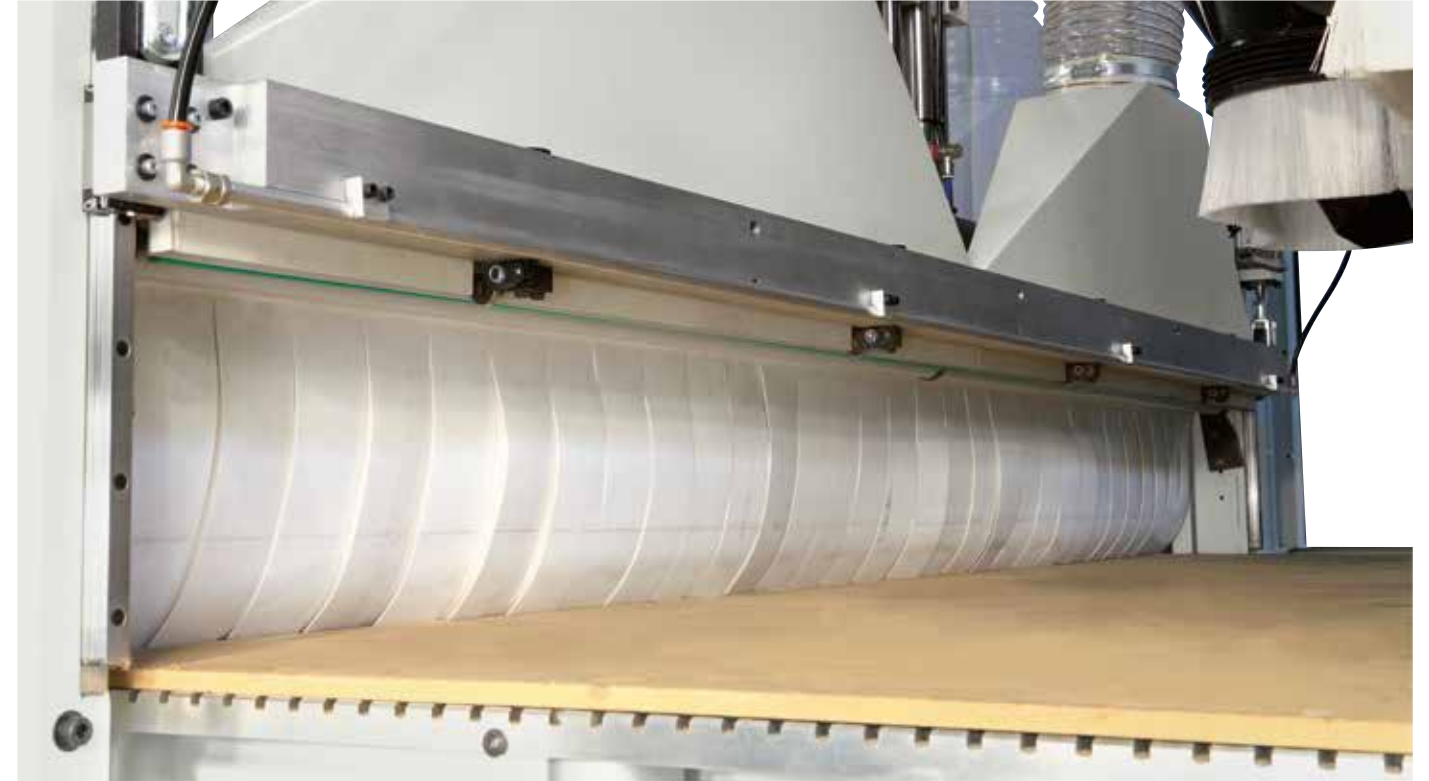
100% 生产率 推动器可将加工好的零件移到下料带上。
