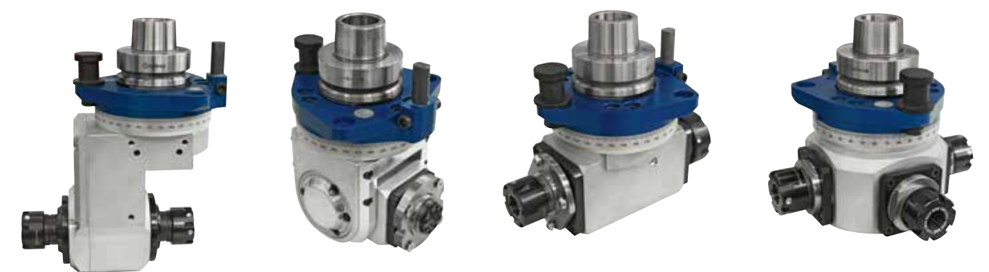
多种定制选择可满足板材、热成型件和高端塑料零件加工的每一个要求 单、双、四输出角度头配备HSK锥形刀柄，并可用于角铣、冲孔和刀片开槽操作，可搭配锁紧器和带固定机械联轴器的补偿反向间隙装置。
