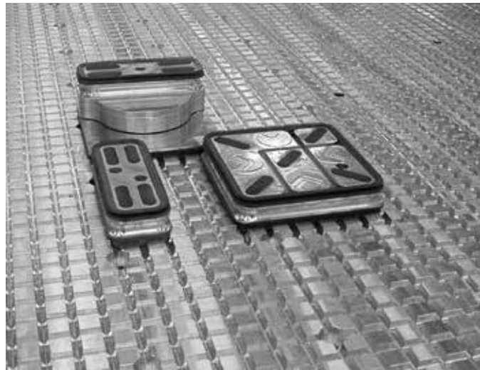
多种MPS和MODULSET吸盘可供选择，可根据要进行的加工将工件固定在工作台面上。 这些设备特别适用于高端塑料零件和板片的复杂加工。
