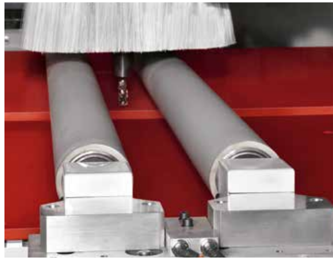
在所有加工情况下都能有最大效率：压辊 在真空密封条件差的情况下，对小工件和塑料条进行完美的夹持。 压辊靠近铣削区域进行压紧，也是加工重叠面板的理想选择。即使在不需要压力辊的铣削操作中，也可以禁用压力辊，而不影响机床性能。
