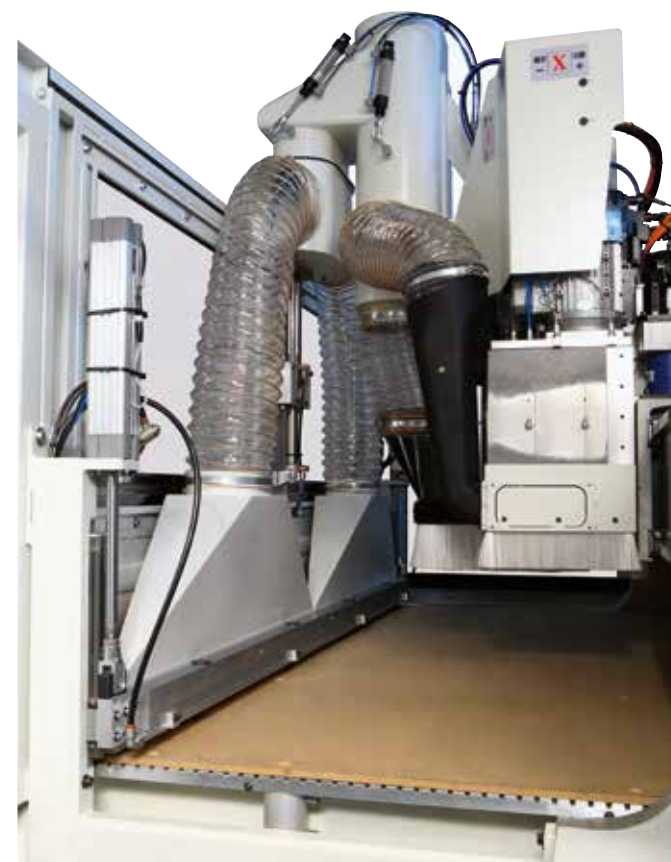
零粉尘 使用清洁加工台面的上部抽吸系统来最大限度地去除塑料碎片。
