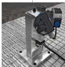
通过自校准系统可以自动恢复操作单元的参数，旋转刀具中心 (RTCP) 编程确保了五轴精度。这是充分发挥五轴加工性能不可或缺的解决方案，尤其针对那些使用了先进材料所制成的高端零件或部件。
