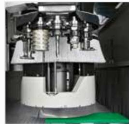
**高度清洁度** 由于采用了双同轴吸罩，在所有的工作条件下都能抽吸切屑和灰尘，从而保证了机器和环境的安全。
