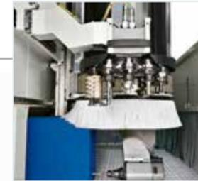
**PRISMA 操作单元** 设有5轴电主轴。
