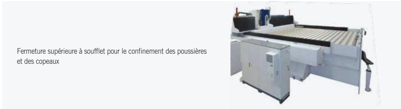
Fermeture supérieure à soufflet pour le confinement des poussières et des copeaux
