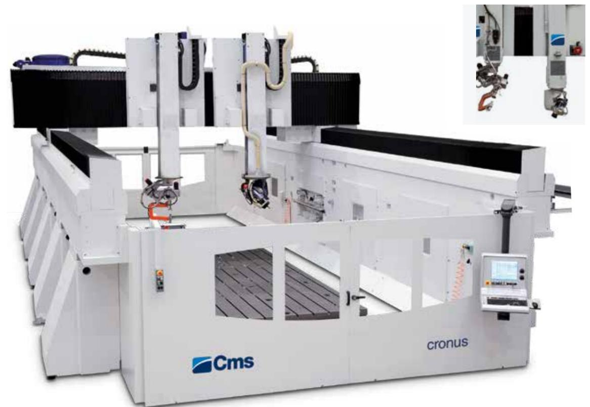
SOLUTION HYBRIDE À 5 AXES : FRAISE + COUPE AU JET D'EAU AVEC COLLECTEUR
