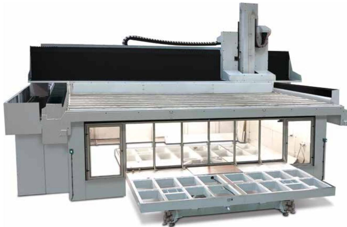
PLAN ROTATIF : SIMPLIFIE LE CHARGEMENT/DÉCHARGEMENT À L'EXTÉRIEUR DE LA MACHINE ET PERMET UN CYCLE PENDULAIRE UTILISANT TOUTE LA ZONE DE TRAVAIL
